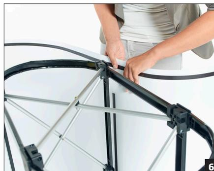
Schieben Sie die Gegenseite der Magnetschienen seitlich in die vorgefertigte Nut oberhalb der Fixatoren.
